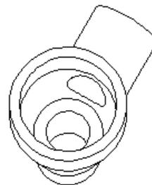
1. Drehen Sie den oberen Teil gegen den Uhrzeigersinn, um den oberen Teil des Ablasshahns zu lösen.
